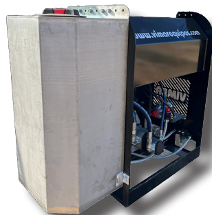
Depósito INOX bomba
